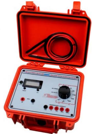
Прецизионный калибратор **5068** подходит для калибровки и проверки универсальных тестеров изоляции при помощи испытательного напряжения до 2,5 кВ.
