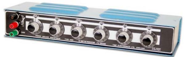
Модель Time Electronics 1065 представляет собой декадный магазин сопротивлений мощности в прочном электростатически экранированном компактном корпусе, предназначенный для использования в научных лабораториях, лабораториях общего назначения и сфере обучения.
