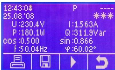
Проверка соединения сети электропитания с помощью отображения векторной диаграммы и измерения напряжения, тока, активной и реактивной мощности, сдвига фазы, коэффициента мощности и частоты.
