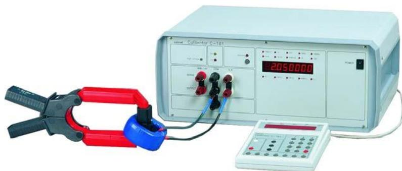
Комплект для проверки токоизмерительных клещей постоянного и переменного тока.
