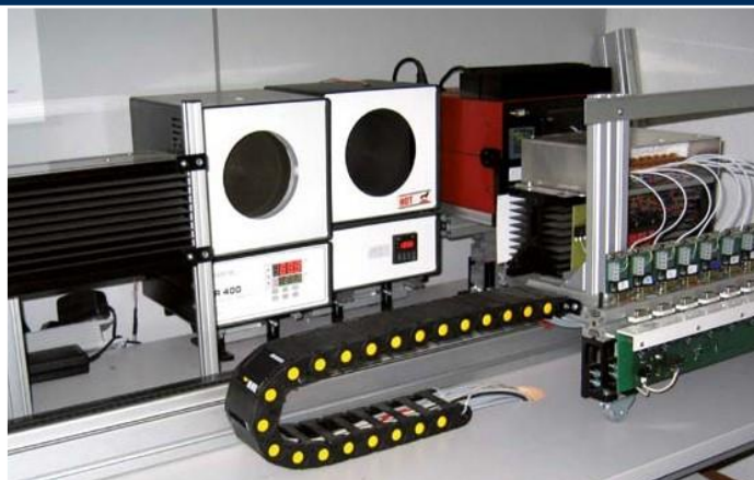
Автоматизированная калибровочная станция в компании Optris GmbH
